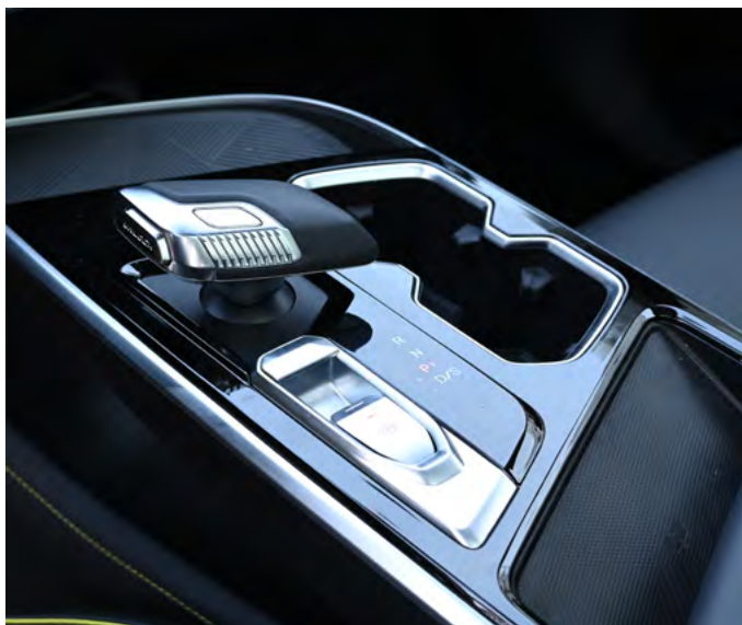
Elektroniczne sterowanie zautomatyzowaną skrzynią biegów 7DCT
